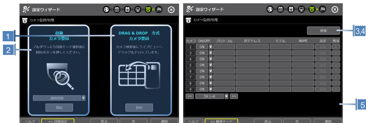
NVRはカメラを検索して NVRに登録するための3つの方法をサポートしています。自動カメラ登録オプションを使用すると、NVRはネットワークをスキャンし、最初に検出したカメラを使用可能なチャンネルに自動的に登録できます。
