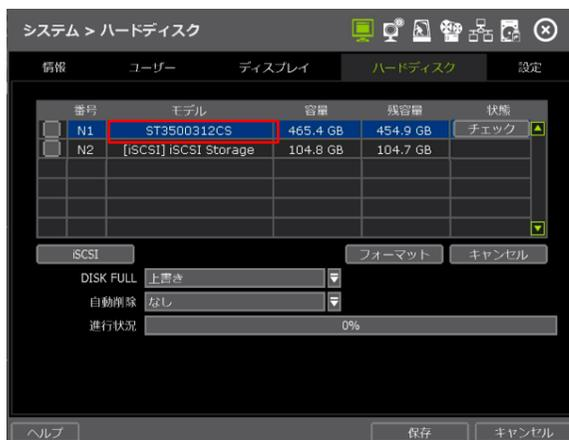
**ノート** iSCSI (Internet Small Computer System Interface) は、データストレージデバイスをコンピューティング環境で接続する IP ベースのストレージネットワーク標準です。iSCSI は、IP ネットワークを介して SCSI コマンドを送信し、データ送信を容易にするため、長距離領域にあるストレージデバイスの管理に使用されます。iSCSI は、データストレージと再接続をサポートします。場所を問わずカバーできます。
